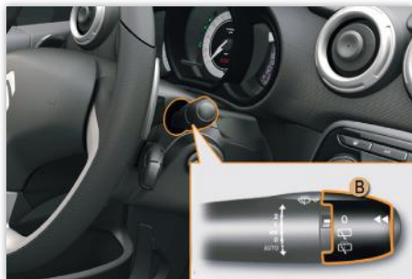
B. anel de seleção do limpa-vidros traseiro:
