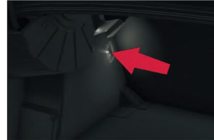
Acende-se automaticamente quando se abre o porta-malas e apaga-se quando se fecha a mesma.
