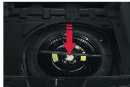
**!** A utilização do conjunto roda e pneu reserva de uso temporário pode alterar o comportamento dinâmico do veículo, principalmente em curvas e frenagens, por este motivo é obrigatório não ultrapassar a velocidade máxima indicada na etiqueta afixada na roda reserva.
