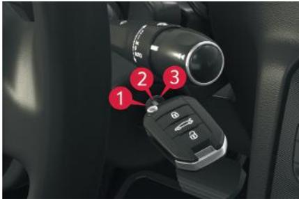
**Posição 1: Stop** - Ignição desligada
