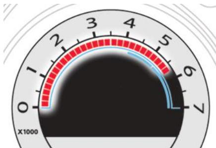
Ao aproximar-se do regime máximo do motor, os quadrados são apresentados a vermelho e de forma intermitente, para lhe indicar a necessidade de engrenar uma marcha superior.
