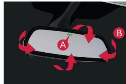
Graças a um sensor **A**, que mede a luminosidade proveniente da traseira do veículo, este sistema garante de forma automática e progressiva a passagem entre as utilizações de dia e de noite.
