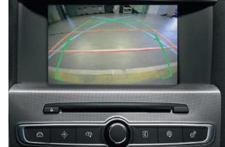
Os traços vermelhos representam cerca de 30 cm após o limite do para-choques traseiro do seu veículo. O sinal sonoro torna-se contínuo a partir deste limite. Os traços azuis representam o raio de giro máximo.
