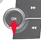
Ajuste os parâmetros um a um, validando com a tecla **OK**. Selecione, em seguida, o separador **"OK"** na tela e, em seguida, valide para sair do menu **Regulagem da data e hora**.
