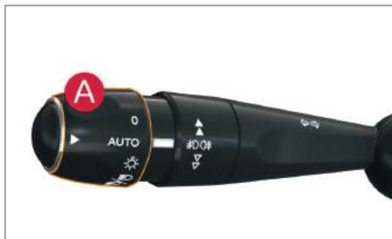
Através de um sensor de luminosidade, em caso de deteção de uma luminosidade externa fraca, as luzes da placa, de posição e faróis baixos, acendem automaticamente, sem ação do condutor. Podem acender em caso de deteção de chuva, em simultâneo com o funcionamento automático dos limpa-vidros dianteiros. Assim que a luminosidade se tornar suficiente ou após a parada dos limpa-vidros, as luzes apagam-se automaticamente.
