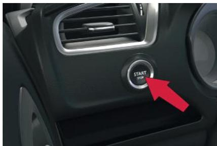
Se uma das condições de partida não for aplicada, é visualizada uma mensagem no painel de instrumentos. Em certos casos, é necessário virar o volante pressionando o botão "START/STOP" para ajudar ao desbloqueio da coluna de direção, é avisado por uma mensagem.
