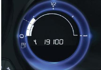
Esta informação é apresentada durante alguns segundos ao ligar a ignição. Informa o condutor sobre o prazo para a próxima revisão a efetuar, de acordo com o plano de manutenção do construtor.
