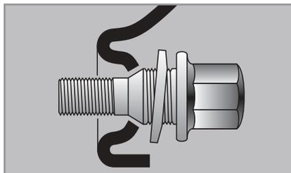
**!** Os parafusos das rodas são específicos para cada tipo de roda. Em caso de troca das rodas originais, verificar com a Rede de concessionárias CITROËN ou em uma oficina qualificada, da compatibilidade dos parafusos com as novas rodas.
