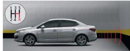
A colocação em funcionamento é obtida através da engrenagem da marcha a ré, sendo acompanhada de um sinal sonoro. A função é desativada quando se desengrena a marcha a ré.
