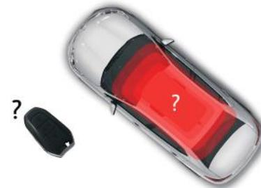
Se a chave eletrônica não se encontrar na zona definida quando o veículo se encontrar em movimento ou quando solicitar a parada do motor (posteriormente), aparece uma mensagem no painel de instrumentos.
