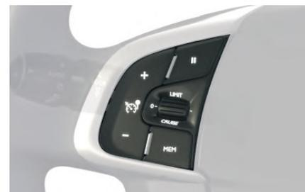
Esta tecla permite selecionar um limite de velocidade memorizado para ser usado com o limitador de velocidade ou o regulador de velocidade.
