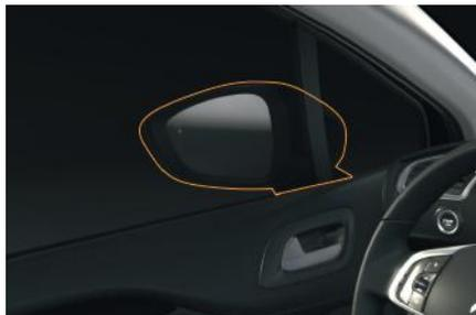
Equipados cada um com um espelho regulável que permite a visualização da zona traseira lateral necessária para as situações de ultrapassagem ou de estacionamento. Os retrovisores podem ser rebatidos para estacionar em passagens estreitas.
