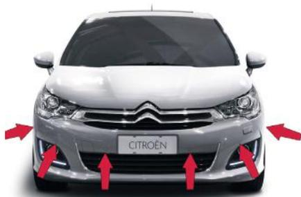
**i** O som difundido pelo altofalante (dianteiro ou traseiro) permite determinar se o obstáculo se encontra na dianteira ou na traseira.
