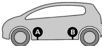
**⚠** A saia lateral é um embelezador plástico. Utilizar as setas existentes nesta peça (posição **A** ou **B**) para posicionar corretamente o macaco na parte inferior da carroceria. A instalação do macaco na saia lateral, provocará a sua quebra e danos significativos à pintura e a carroceria do veículo.
