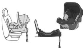
Instala-se de "costas para a estrada". Instala-se com uma base ISOFIX fixada nas argolas **A**.
