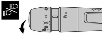
Empurre a alavanca em direção ao painel para ativar os faróis altos. Para desativar os faróis altos, retorne a alavanca para a posição central puxando em direção ao volante.
