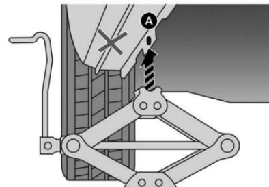
**i** Levantar o veículo até que a roda se eleve o suficiente para realizar a retirada e colocação da roda sobressalente.
