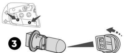
Após substituição da lâmpada, realizar a montagem da lanterna na sequência inversa acima.
