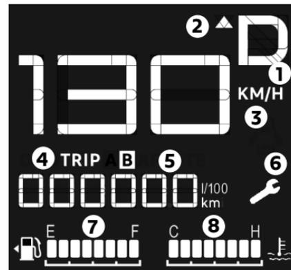
1. Posição do seletor e marcha engrenada na caixa automática.
