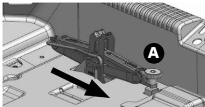
Para recolocar o macaco no seu suporte, deslizar o macaco no sentido inverso da seta para encaixar no suporte, e depois, recolocar a porca de fixação **A** e girar no sentido horário.
