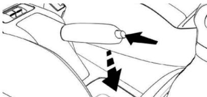
⚠ Sempre que estacionar em uma ladeira, vire as rodas contra o passeio para imobilizar, acione o freio de estacionamento, engrene uma marcha e desligue a ignição.
