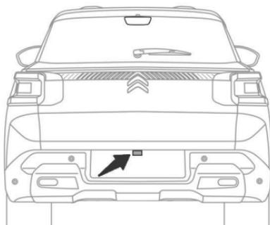
Uma câmera traseira é ativada automaticamente ao engrenar a marcha a ré. A imagem colorida é mostrada na tela de navegação.
