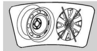
Não exceda a velocidade máxima autorizada indicada na etiqueta fixada na roda. É proibido conduzir com mais do que uma roda sobressalente de utilização temporária.
