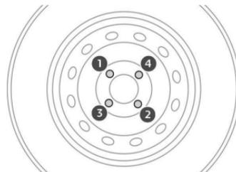
**!** Parafusos de roda apertados de maneira incorreta podem se soltar durante a condução e causar acidentes, ferimentos graves e perda de controle do veículo. Siga sempre as prescrições do manual.
