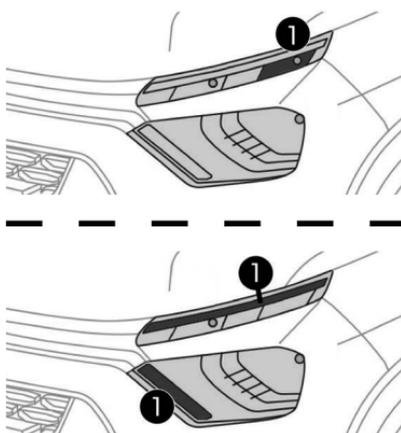
Conforme a versão (\*), as luzes diurnas **1** podem ser em **LED** ou lâmpadas halógenas.
