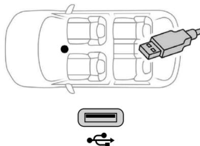
Uma tomada USB encontra-se no console central e permite ligar um equipamento portátil, como um iPod® ou um pen drive USB.
