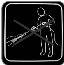
Para não danificar os componentes elétricos do veículo, é expressamente **proibido** utilizar a lavagem a alta pressão no compartimento do motor.
