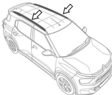
**⚠** As barras longitudinais de seu veículo não foram projetadas para transporte de carga e instalação de barras transversais.
