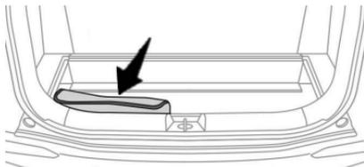
As ferramentas e o triângulo estão instaladas em uma bolsa fixada com velcro sobre o piso do porta-malas.
