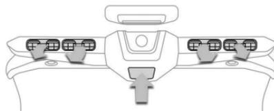
O ventilador de teto permite a recirculação do ar interno sugando o ar da cabine pela abertura inferior e lançando-o pelas quatro aberturas em direção à 2ª e 3ª fileiras.
