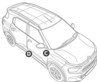
**C. Etiqueta autodestrutiva**, fixada na coluna da porta do passageiro, embaixo do assento do passageiro e no vão do motor, com o Número de Identificação Veicular (NIV ou VIN).
