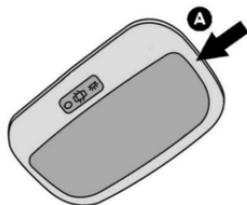
Desencaixe a tampa da luz de teto traseira com uma chave de fenda de ponta fina no entalhe indicado pela seta **A**, para acessar a lâmpada com defeito.
