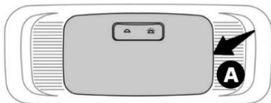
Com uma chave de fenda de ponta fina, solte com cuidado toda a moldura que envolve a lâmpada de cortesia. Remova a lâmpada defeituosa e substitua-a. Coloque o console de volta no lugar ao redor da luz de cortesia e prenda-o corretamente.
