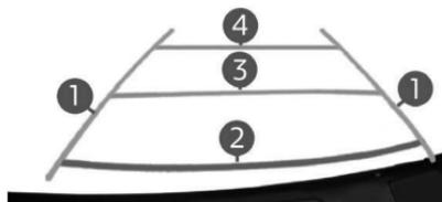
Os traços laterais **1** representam a direção geral do veículo (a distância corresponde à largura do veículo sem os retrovisores).
