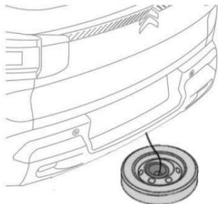
A roda sobressalente é fixada por um sistema de guincho por baixo da parte traseira do veículo.
