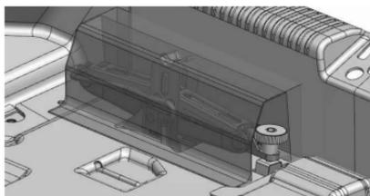
Para retirar o macaco do seu suporte, girar a porca de fixação do macaco **A**, no sentido anti-horário. Deslizar o macaco conforme o sentido da seta para soltar do suporte.
