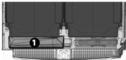
O triângulo **1** está acondicionado em uma bolsa fixada com velcro do lado esquerdo do porta-malas. As ferramentas **2** e **4** estão acondicionadas na bolsa de ferramentas **5** localizada no lado direito do porta-malas entre o macaco **3** e a travessa traseira.
