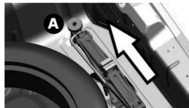
Para recolocar o macaco no seu suporte, feche completamente o macaco e encaixe a manivela na lateral do macaco conforme imagem **3** da página anterior. Deslizar o macaco até o final do suporte no sentido inverso da seta, de maneira que ele apoie corretamente no seu suporte. Recolocar a porca de fixação **A** e girá-la no sentido horário até completa fixação do macaco.
